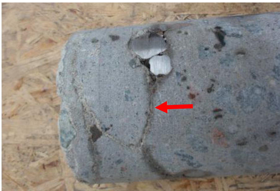
Figur 23: Skikt av bentonit i täckskiktet.
