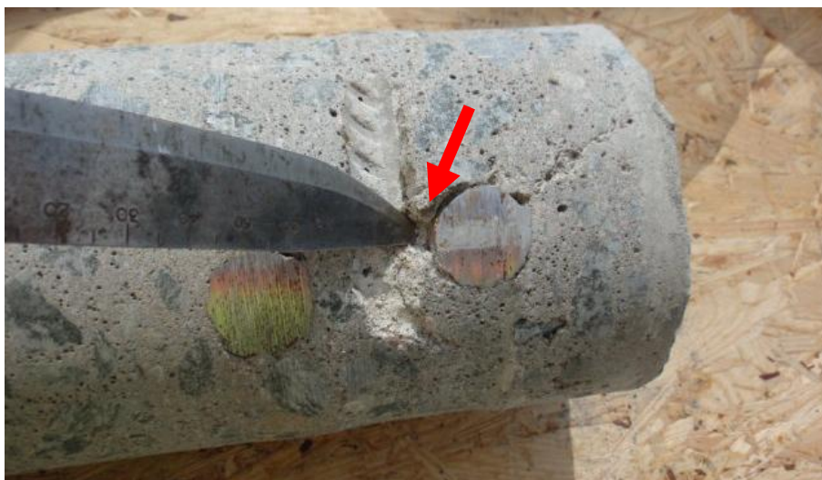
Figur 17: Exempel på ansamling av bentonit vid korsande armeringsjärn.
