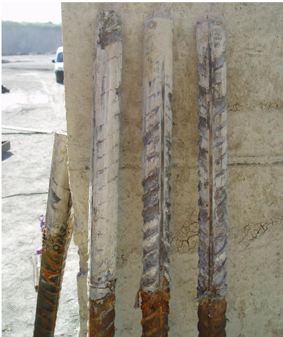
Figur 41: Utdragna armeringsjärn \text{\O}32\text{mm} med ingjutningslängd 320mm i vägg S2.
