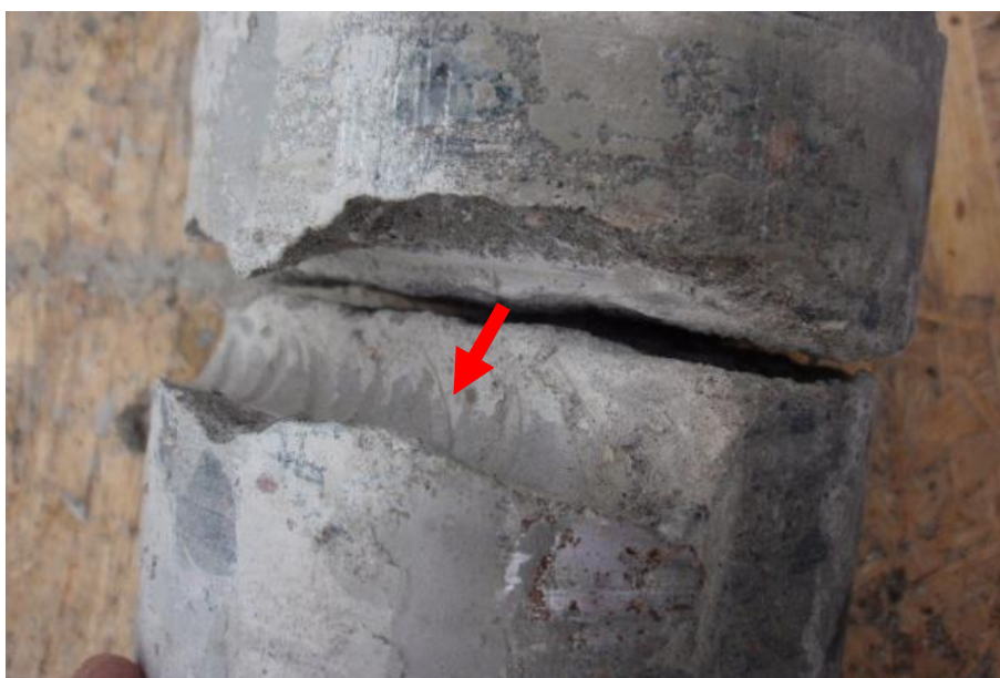
Figur 22: Avtryck efter armering i betong.
