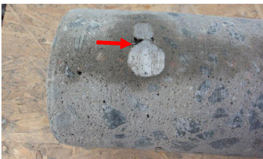
Figur 18: Exempel på ansamling av bentonit vid omlottskarv.
