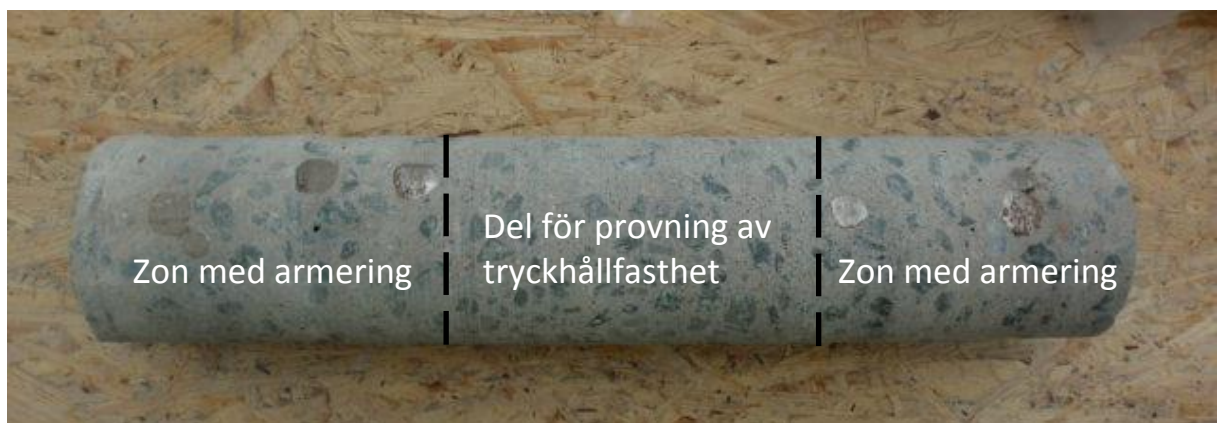
Figur 26: Exempel på var i väggen som provkroppen för provning av tryckhållfasthet tas ut.
