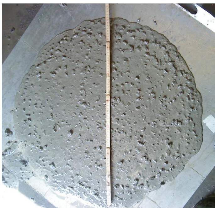
Figur 2: Flytsättmått för Slitsmursbetong 2 direkt efter blandning.
