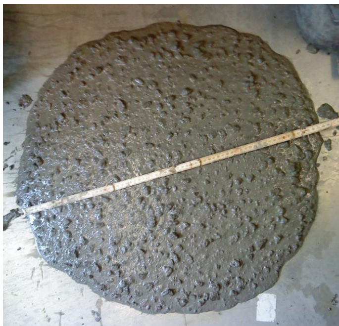
Figur 1: Flytsättmått för Slitsmursbetong 1 direkt efter blandning.
