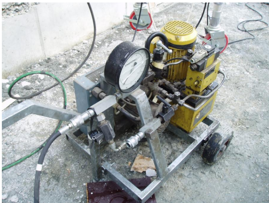
Figur 37: Hydraulpump som användes vid utdragsprover.
